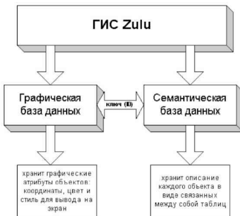
Рисунок 7.1. Структурная схема представления информации в системе Zulu
