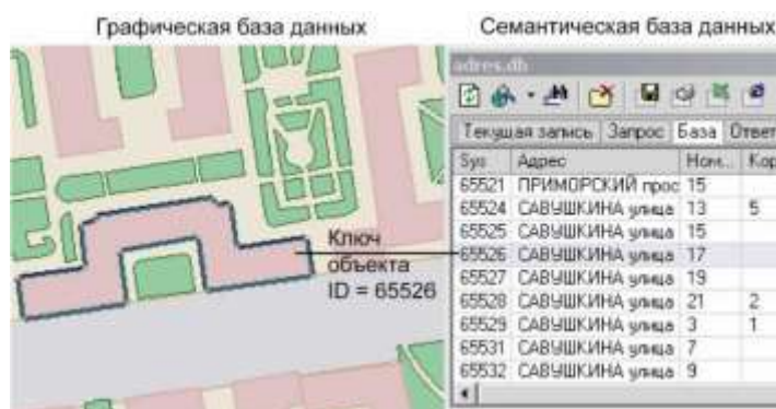
Рисунок 7.2. Пример взаимодействия семантической и графической баз данных
